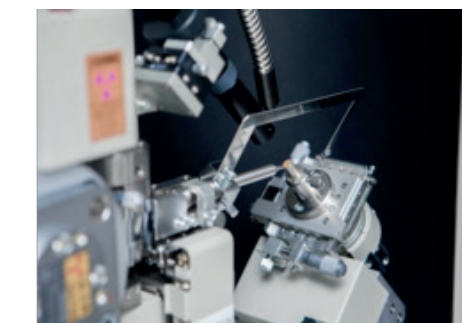
V oblasti štruktúrnej analýzy sme vybudovali RTG systém (V. Kavečanský, P. Diko) tromi difraktometrami RIGAKU, ktoré umožňujú komplexnú RTG difrakčnú analýzu materiálov.
