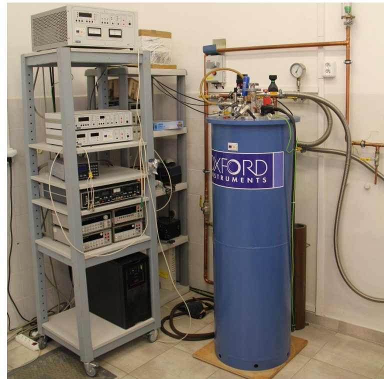
Meracia mikrokontaktová aparátúra vhodná na 4bodové odporové merania
